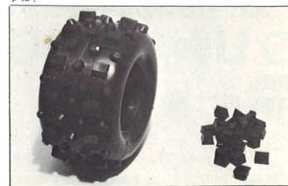
★352 XS スパイクタイヤ (オプション) イボタイヤに、スーパースパイクを接着することにより、強力な威力を発揮。
